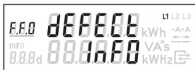
Der Zähler darf dann nicht mehr zu Abrechnungszwecken herangezogen werden. Die Rücksetzung des Fehlercodes ist vor Ort nicht möglich.
