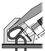
6. Entfernen Sie den Schraubendreher, so dass die Klemme sich schließt.
