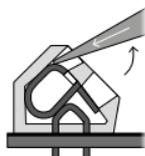
5. Führen Sie den Leiter bis zur Isolierung in die geöffnete Klemme ein. Achten Sie darauf, dass die Kabelisolierung nicht mit geklemmt wird.
