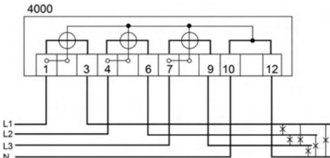
Bei Einsatz von 60A-Zählersteckstiften darf das Gerät nur bis zu einem Grenzstrom von 60A betrieben werden.
