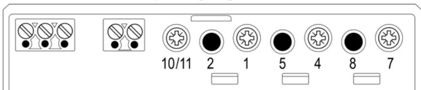
Anschlusschaltbild für die 4-Leiterausführung, direkt angeschlossen **ohne** Spannungsabgriff:
