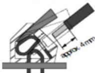
6. Entfernen Sie den Schraubendreher, so dass die Klemme sich schließt.
