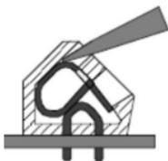
5. Führen Sie den Leiter bis zur Isolierung in die geöffnete Klemme ein. Achten Sie darauf, dass die Kabelisolierung nicht mit geklemmt wird.
